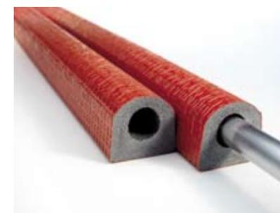
EXZENTROFLEX®, предназначена для изоляции систем отопления пола, покрыта защитной PE плёнкой. Специальная форма позволяет более прочно крепить изоляцию. Так же за счет своей формы уменьшается расход бетона для заливки пола.
