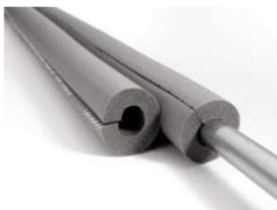
Высококачественная каучуковая изоляция INSUL® в форме трубок, дополнительно оснащённая двумя клейкими лентами. Разработана для тех случаев, когда изоляцию устанавливают на уже смонтированные трубы.
